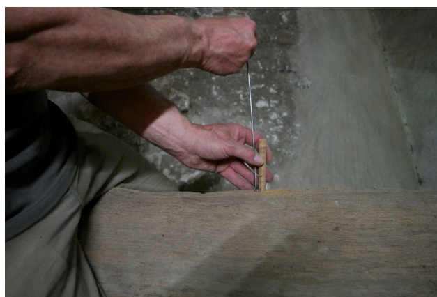
7. Met behulp van de snijhaak, voorzien van een haakje aan het uiteinde, kan het monster eenvoudig uit de balk worden gehaald.
