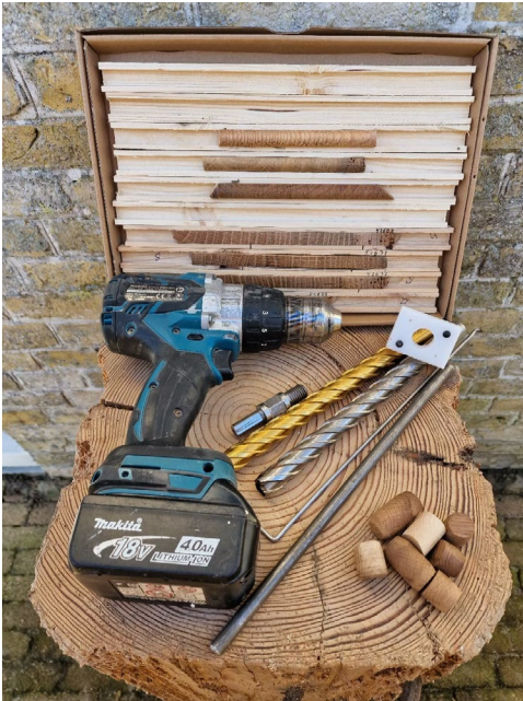
3. Een complete boorset, met accuboormachine, een geleider, twee boren, een snijhaak en een uitdrukstaafje en stoppen om in het boorgat te slaan. Op de achtergrond staan 'gootjes' om de genomen boorstalen in te transporteren.
